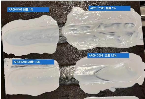
在 带锈Q235钢板的埋弧焊缝上涂刷单组份水漆，然后立即至于水浴锅中，在高温高湿的状态下干燥，挂差干燥过程中的闪锈。发现闪锈基本都出现在焊缝上，其他板面不易闪锈，因为焊缝在高温下 杂质含量较多，这些杂质和铁非常容易形成电极电位差，所以非常容易锈蚀。
