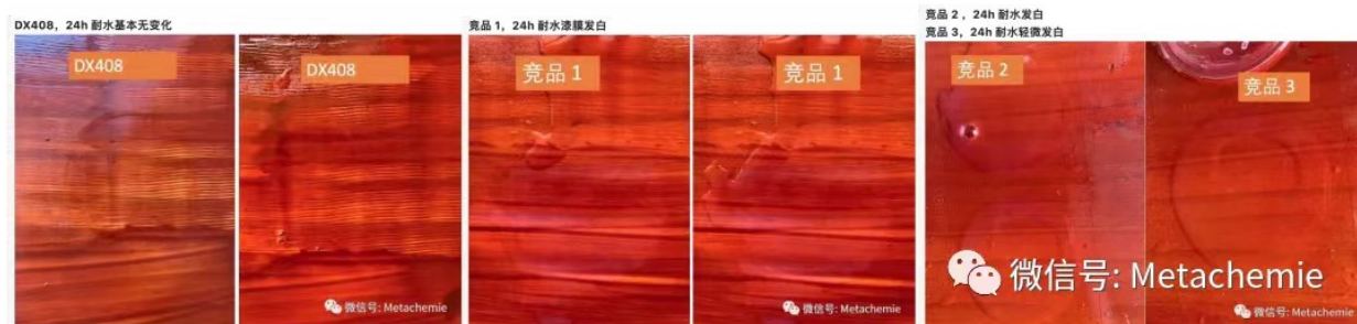
DX408 和竞品 对木器漆的耐水表现， DX408 表现出更好的耐水性
