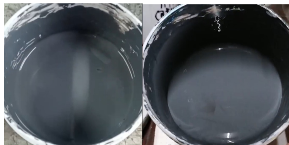
ARS-1 在醇酸和环氧酯体系中有很好的防浮色效果，存储 8 个月无分水、沉降和浮色
