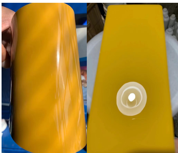
FX540在水性 2K 聚氨酯面漆中优异的相容性和外观表现
