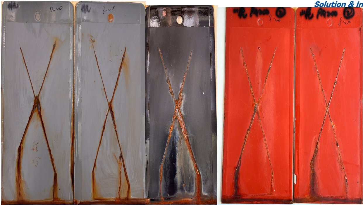
乳液 PA200+ 防锈颜料 XPA-A +分散剂 DX 408+ARCH100S 闪锈剂 650 钢板上, 720h盐雾 24小时的盐雾表现 (冷轧钢板, 打磨, 50μm) 0 级
