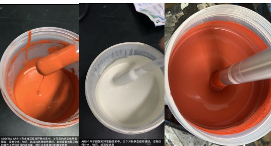
ADDITAL ARS-1 在 2K 环氧和醇酸、环氧酯体系中拥有长效的增稠、防沉、防止分水的效果
