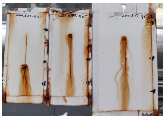
Realcare XPA-A 在 丙烯酸乳液中的盐雾表现 冷轧钢板、50 微米、742h 中性盐雾
