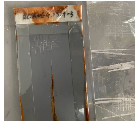
乳液 PA200+ 防锈颜料 XPA-A +分散剂 DX 408+ARCH100S 闪锈剂 650 钢板上, 720h盐雾 24小时的盐雾表现 (冷轧钢板, 打磨, 50μm) 0 级
